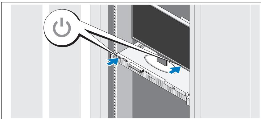
Drücken Sie den Netzschalter am System und am Bildschirm. Daraufhin sollten die Betriebsanzeigen aufleuchten.
