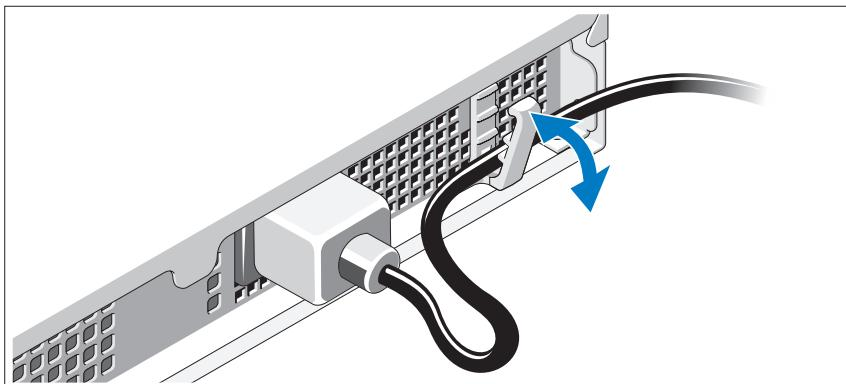
Doble el cable de alimentación del sistema como se muestra en la ilustración y fíjelo en el gancho de retención.
