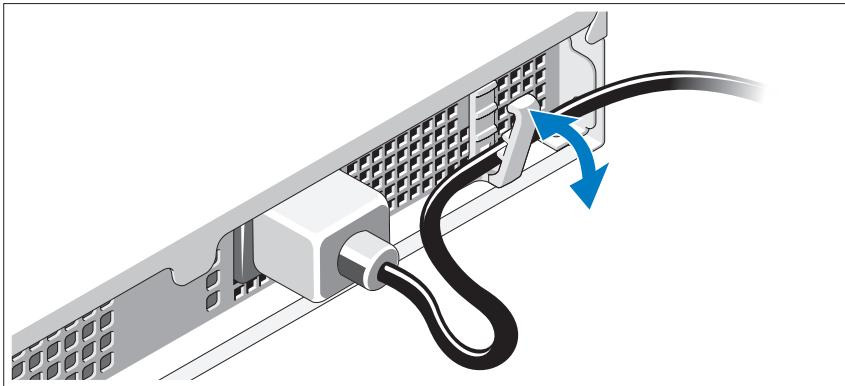
Κάμψτε το καλώδιο τροφοδοσίας συστήματος, όπως υποδεικνύεται στην εικόνα, και ασφαλίστε το καλώδιο στο κλιπ συγκράτησης.
