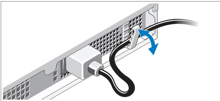
Ohněte napájecí kabel systému, jak je znázorněno na obrázku, a připevněte jej do retenční svorky.
