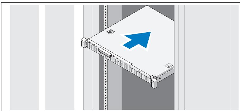
Смонтируйте направляющие кронштейны и установите систему в стойку согласно инструкциям по технике безопасности и инструкциям по монтажу в стойку. Эти инструкции прилагаются к системе.
