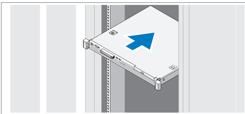
Συναρμολογήστε τις ράγες και εγκαταστήστε το σύστημα σε ράφι σύμφωνα με τις οδηγίες ασφαλείας και τις οδηγίες εγκατάστασης σε ράφι που παρέχονται με το σύστημά σας.
