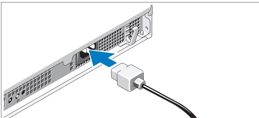
Schließen Sie das System-Netzstromkabel an das System an. Falls ein Bildschirm verwendet wird, schließen Sie auch hier das zugehörige Netzstromkabel an.
