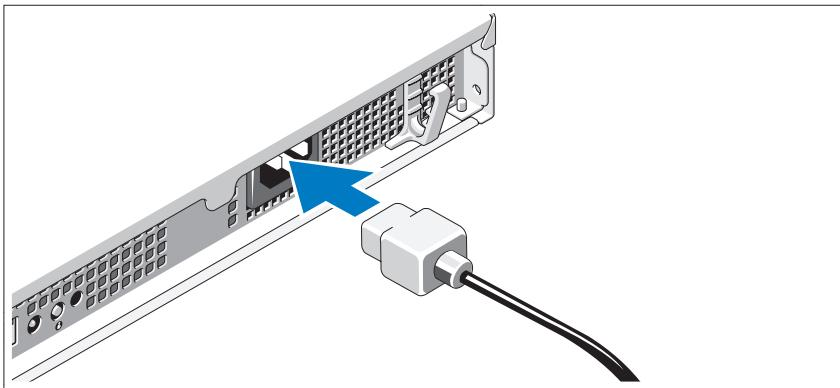
Podłącz odpowiedni kabel zasilania do komputera oraz odpowiedni kabel zasilania do monitora, o ile jest używany.
