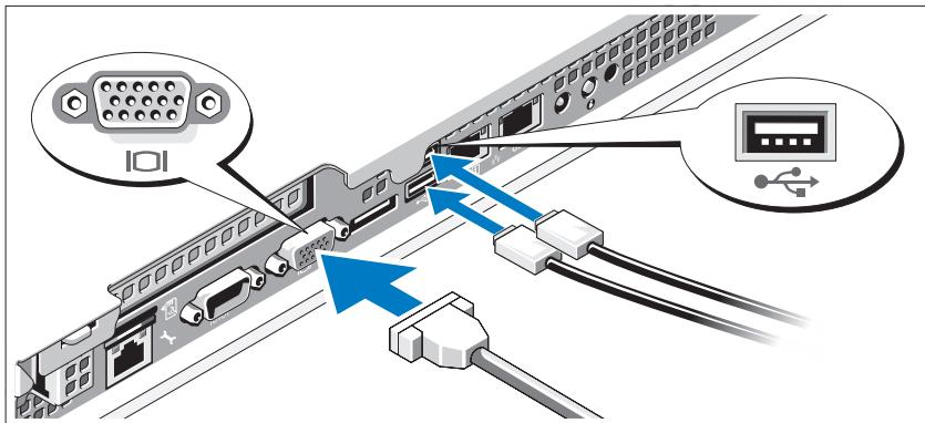
Подключите клавиатуру, мышь и монитор (дополнительно).
