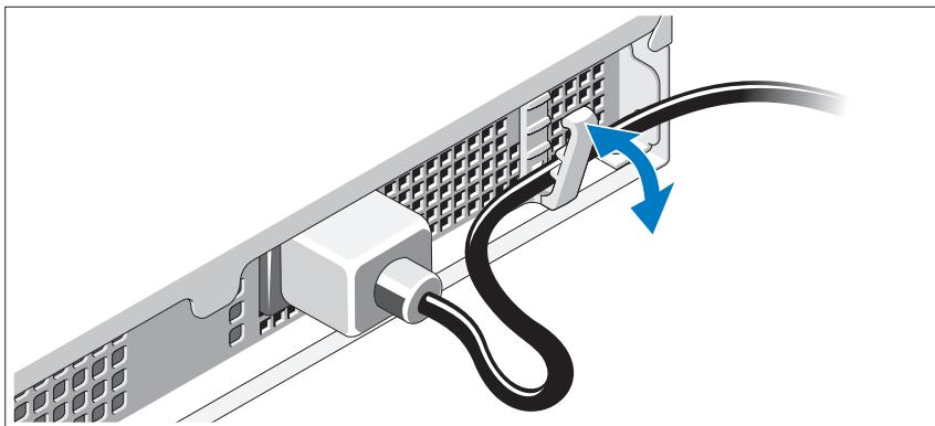
Führen Sie das Kabel wie in der Abbildung dargestellt und sichern Sie es mit dem Halteclip.
