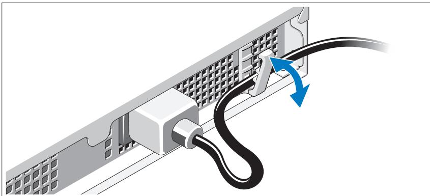
Zegnij kabel zasilacza w sposób przedstawiony na rysunku i zamocuj kabel, używając zacisku podtrzymującego.
